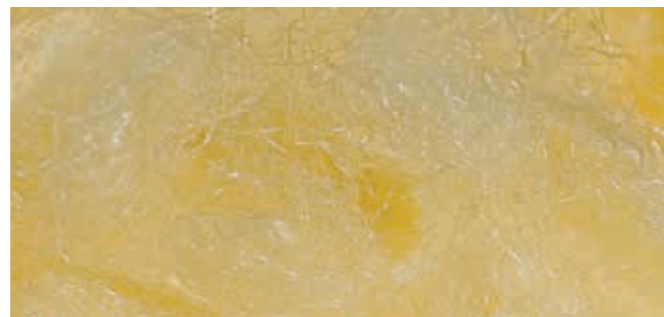
Диаметр волокна: 10 микрон Площадь поверхности: 1000 см 2 /г
